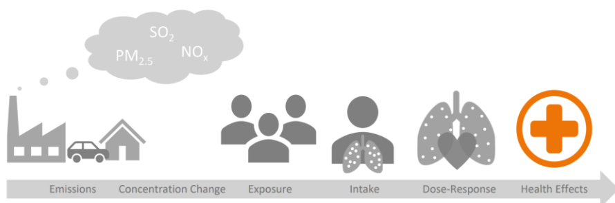
Figura 6-1: Diagrama del impacto de emisiones en concentración de PM 2.5 , exposición e impactos en salud.
