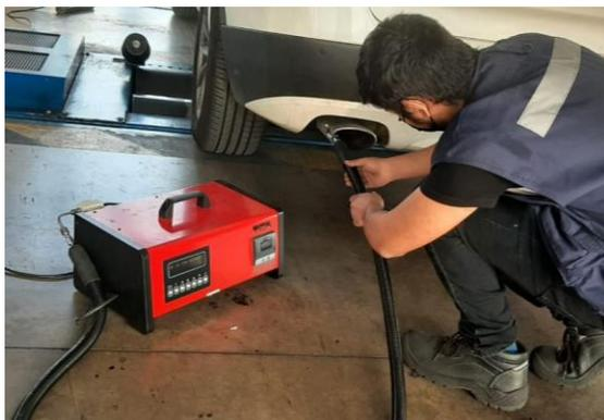
Figura 2: Personal de Purexhaust realizando medición en PRT de La Reina con instrumento AEM de TEN.
