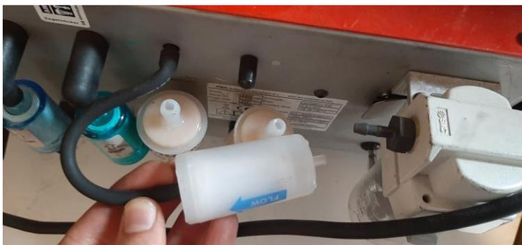
Figura 9: Filtro HEPA instalado en la línea principal del AEM de TEN.
