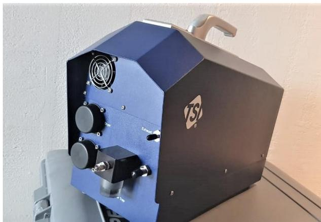
Figura 4: Instrumento de medición de nanopartículas APET de TSI
