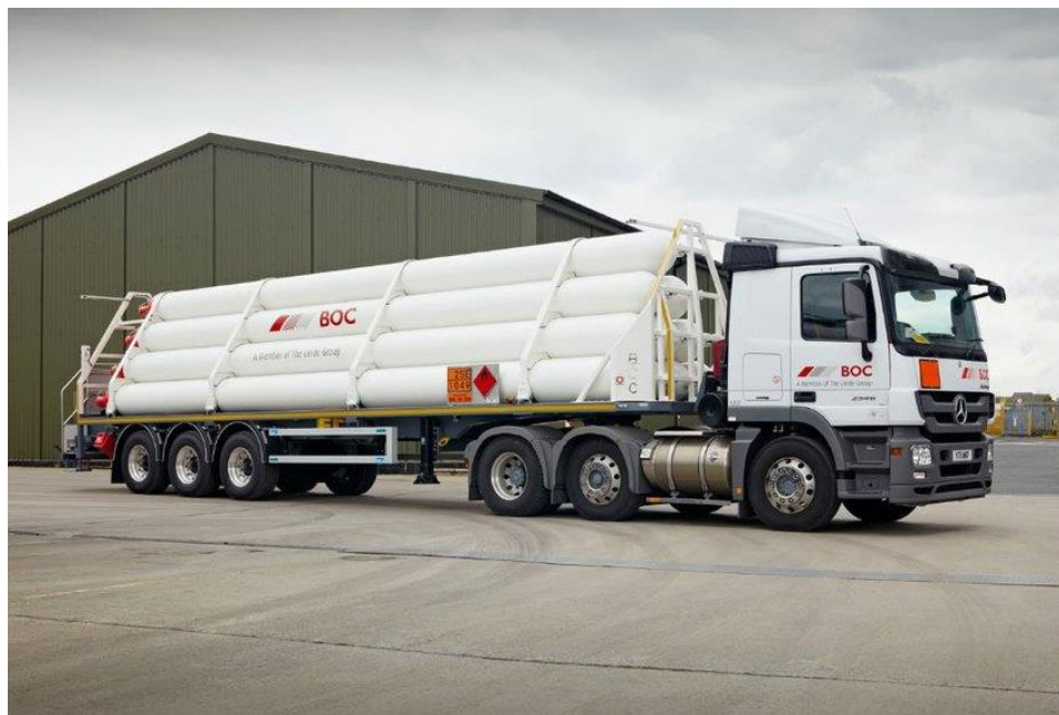
Figura 10: Camión Tube Trailer
